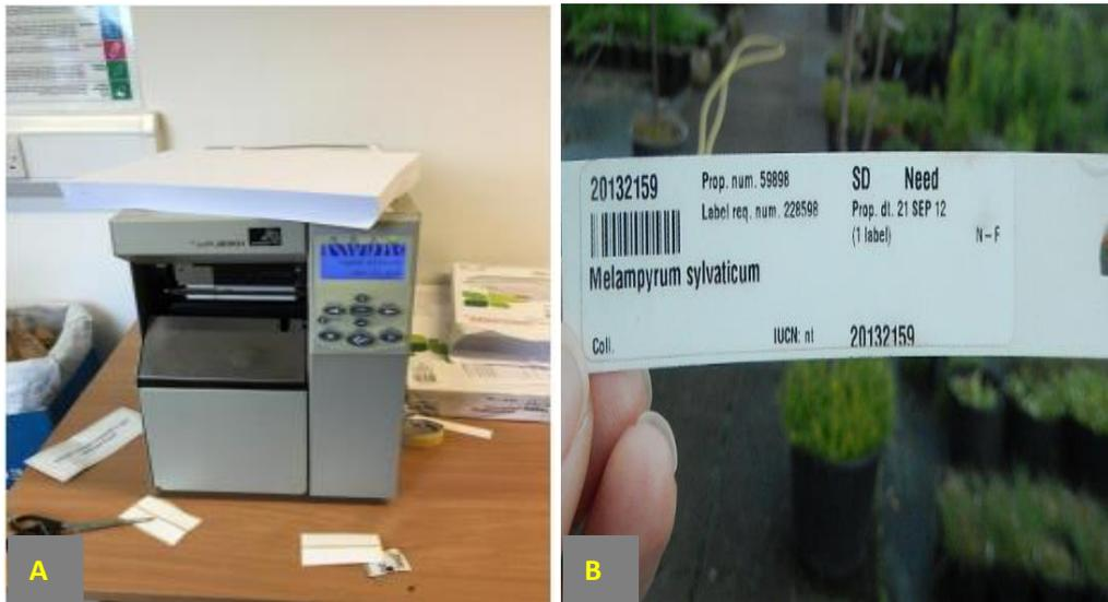
图 A：植物标牌打标机；图 B：初始植物标牌（粘粘式）
