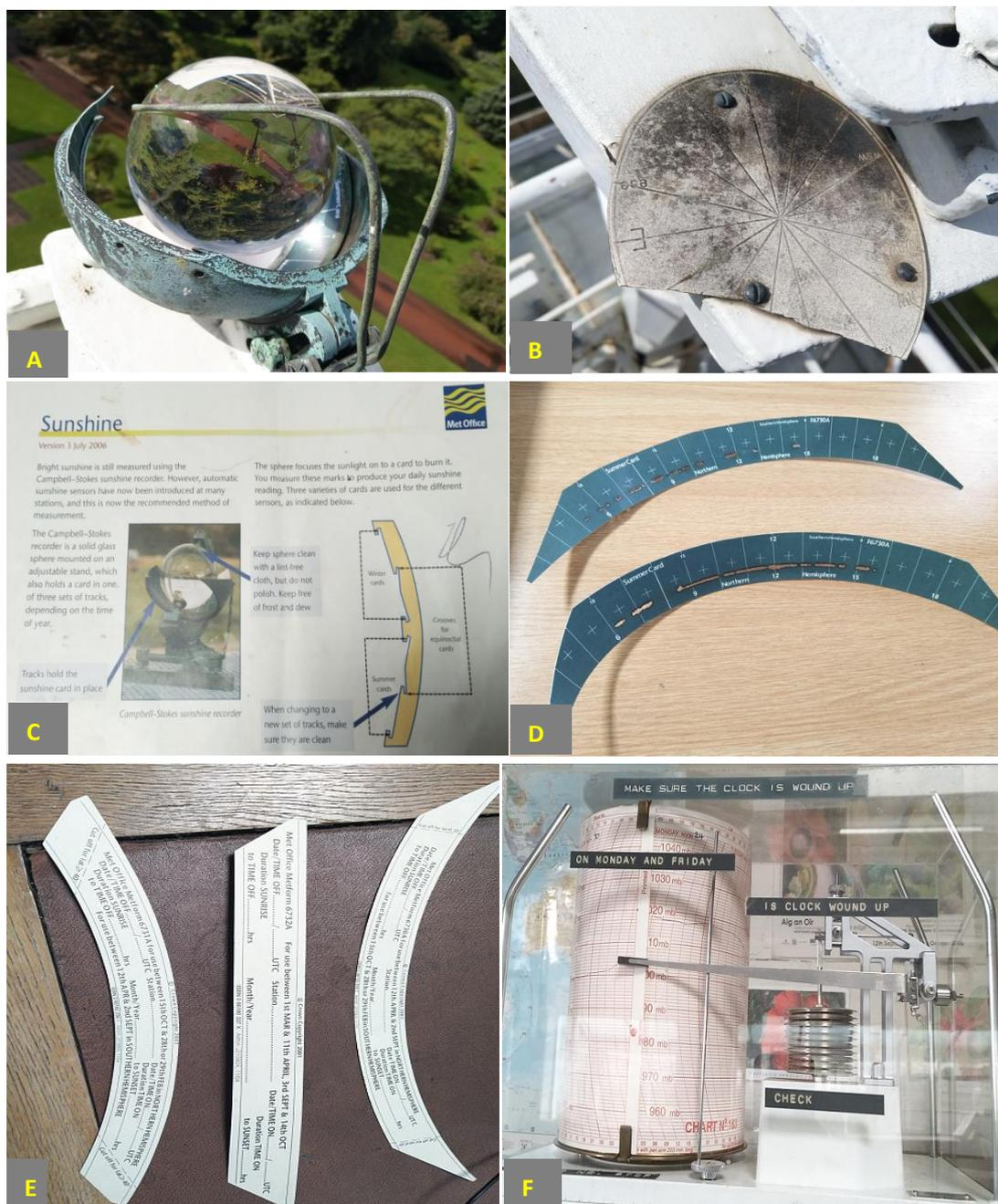
图 A: Campbell-Stokes 水晶玻璃球；图 B: 棕榈温室顶部方向指示牌；图 C: Campbell-Stokes 水晶球使用方法；图 D、E: 光照记录卡；图 F: 压力测量仪
